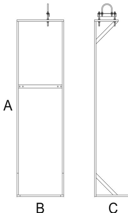
Рис. 29 Стойка для модулей МПА
